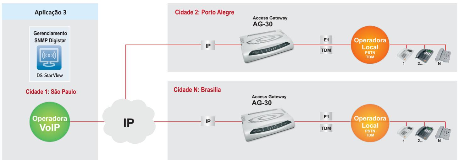
Na **Aplicação Back to Back** o Access Gateway AG-30 realiza o transporte de TDM (E1) através de SIP (G.729).
