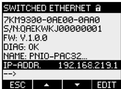
Esquema 6-3 Módulo de expansão 7KM PAC Switched Ethernet PROFINET - Informações no 7KM PAC
