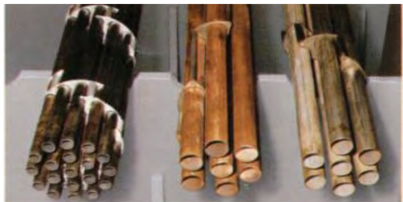
Figura 5 : Tubos do trocador de calor casco-tubo
