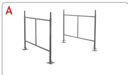
**A)** Montar os dois primeiros painéis sobre as bases (fixas ou ajustáveis) ou rodas.
