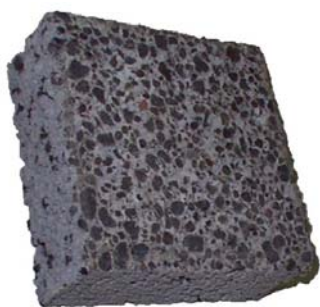
Figura 14 : Aspecto de um bloco arquitectónico em betão leve LecaDecor® imitando uma parede de granito
