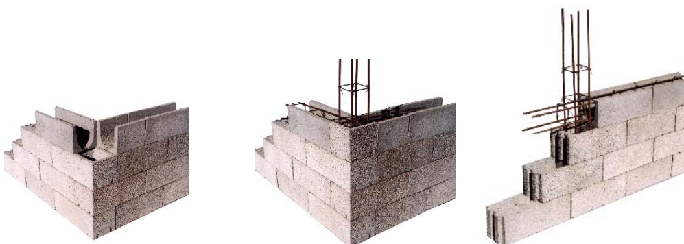
Figura 18 : Aspecto da solução de algumas singularidades propostas pelo “ Sistema Leve Industrial ®”
