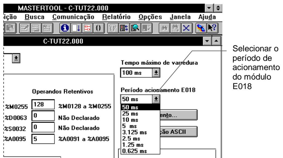
Figura 5-15 Configurando período de acionamento do E018
