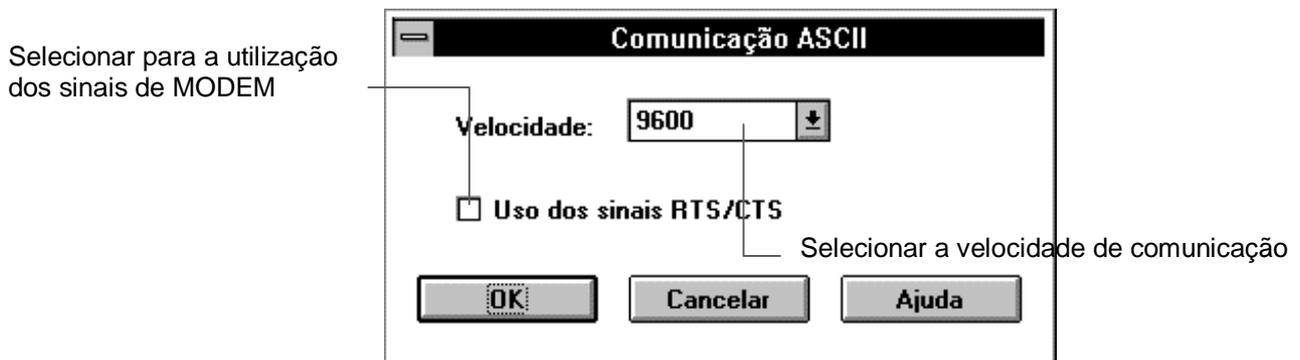
Figura 5-19 Configuração da comunicação ASCII
