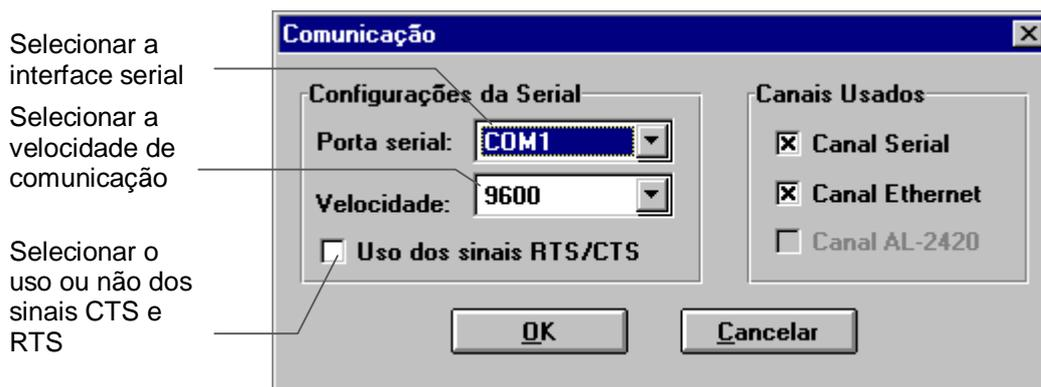
Figura 5-55 Configurando a comunicação Serial
