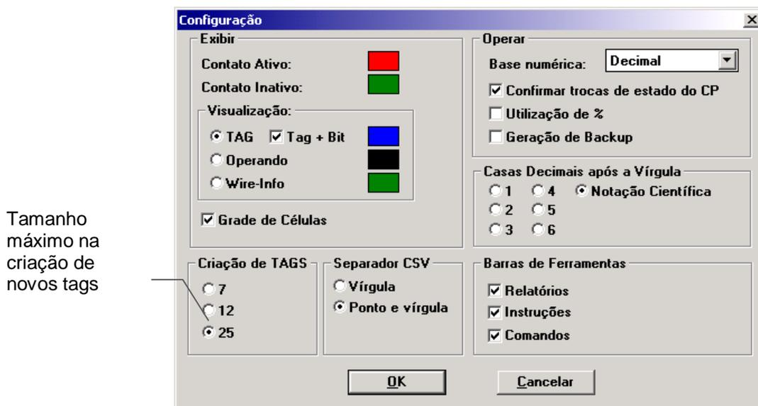
Figura 5-103 Configurando o Tamanho Máximo de Novos Tags
