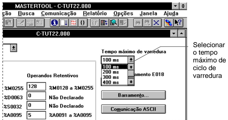
Figura 5-14 Configurando o ciclo de varredura
