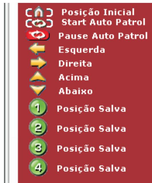
Start Auto Patrol – Clique para iniciar o Auto PTZ, ou seja, ela se movimenta automaticamente, seguindo configurações realizadas dentro do Sistema SHR que indicam: Tempo de cada movimentação e Ângulo de abertura da Rotação
