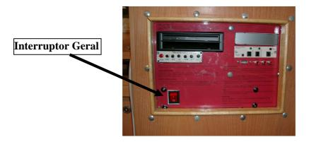
Carregar no interruptor geral vermelho do móvel, conforme indicado na figura anterior. O interruptor acende-se. Se o interruptor não ficar acesso, chamar o pessoal de segurança para controlar o quadro eléctrico da sala.
