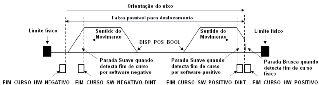
Figura 3-26. Montagem do eixo
