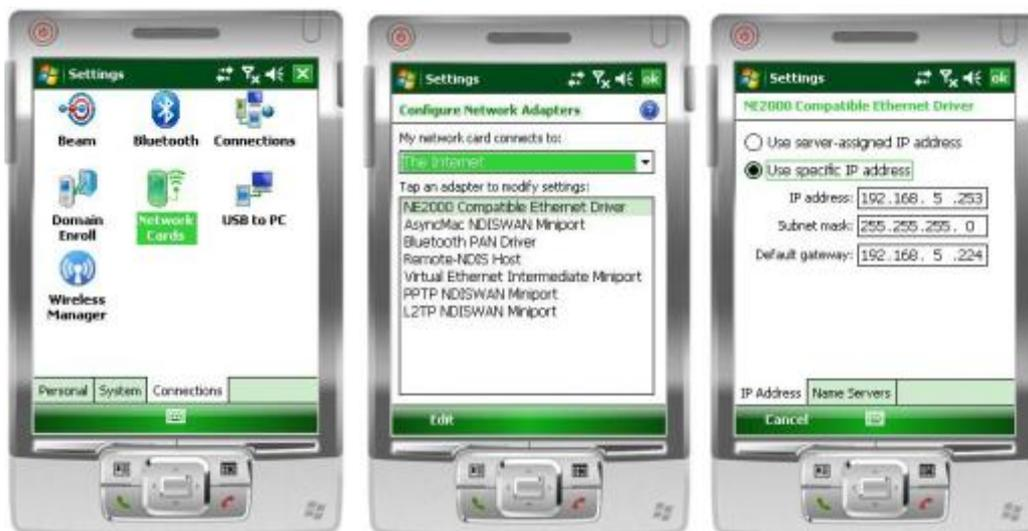
Fig.41 À esquerda configuração de ligações de rede, ao centro configuração dos interfaces, à direita configuração de IP
