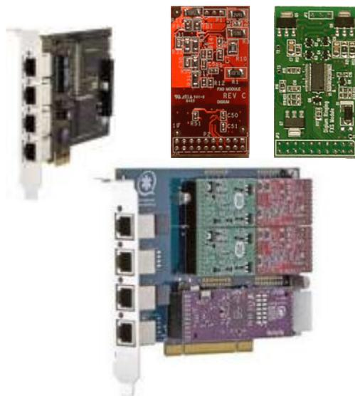
**Fig.49** Placa TDM410 sem interfaces (cima à esquerda), interface FXS (cima ao centro), interface FXO (cima à direita), placa TDM410p com interfaces colocados (baixo).
