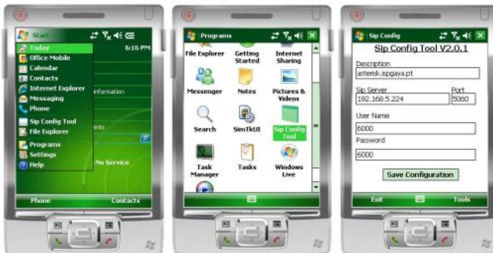
**Fig.43** Configuração da aplicação para utilização VoIP.
