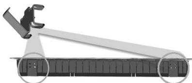
A zona de apoio do vidro é guarnecida com uma borracha adesiva. Não utilizes silicone pois pode provocar danos no vidro se pretenderes remover a PCI futuramente.
