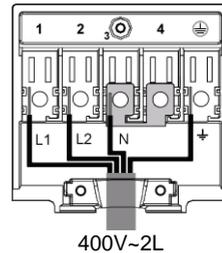
As ligações na parte inferior da PCI devem ser realizadas dependendo do tipo de instalação eléctrica da habitação: caso a instalação seja monofásica deve ser implementado o esquema de 230V~, caso seja trifásica segue o esquema de 400V~2L.
