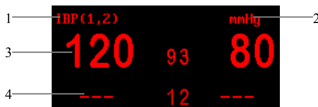
Figura 15-2 Janela de parâmetros de PI
