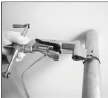
Pressione o eixo da alavanca para que a fita possa ser colocada nas ranhaduras da ferramenta. Empurre o "nariz" da ferramenta contra o fecho.
