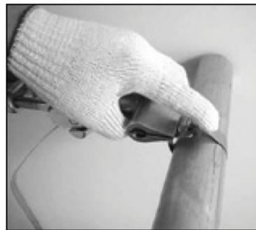
Coloque o dedo entre as abas do fecho e aplique tensão girando a alavanca no sentido horário.
