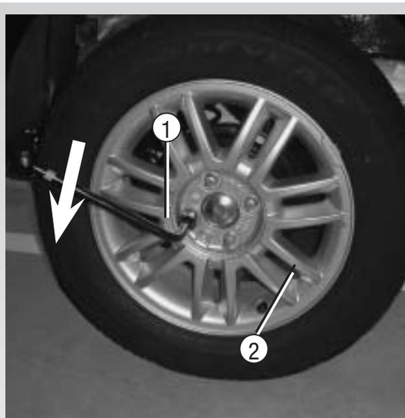
Retire a calota (consulte a página anterior). Antes de erguer o veículo com o macaco, afrouxe meia-volta os parafusos (prisioneiros de roda) utilizando a chave de roda (1), colocado a mesma de forma que o esforço seja exercido para baixo, conforme a figura.
