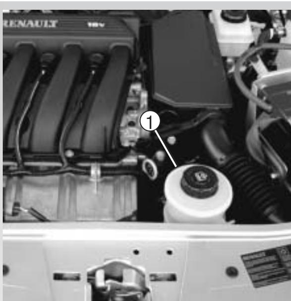
**Reservatório de fluido de direção hidráulica.**
