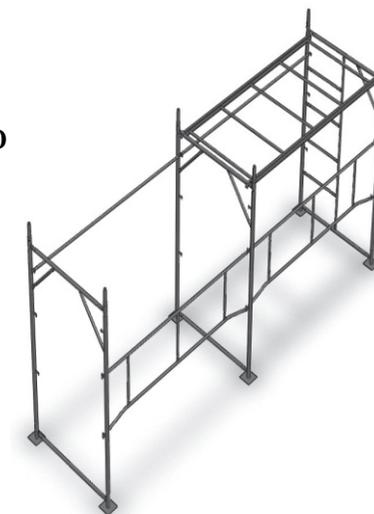
C) Continuar a montagem no sentido da fachada da edificação, repetindo a mesma operação. O primeiro painel com escada (PVE) deve ser posicionado na extremidade do conjunto, conforme a ilustração acima.
