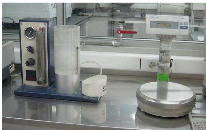
**Figura 9** – Instala o para a medi o do  ndice de fluidez. Do lado esquerdo da imagem est  um fluid metro AS-100 Sames e do lado direito a balan a utilizada nestas pesagens (adaptado de [2]).
