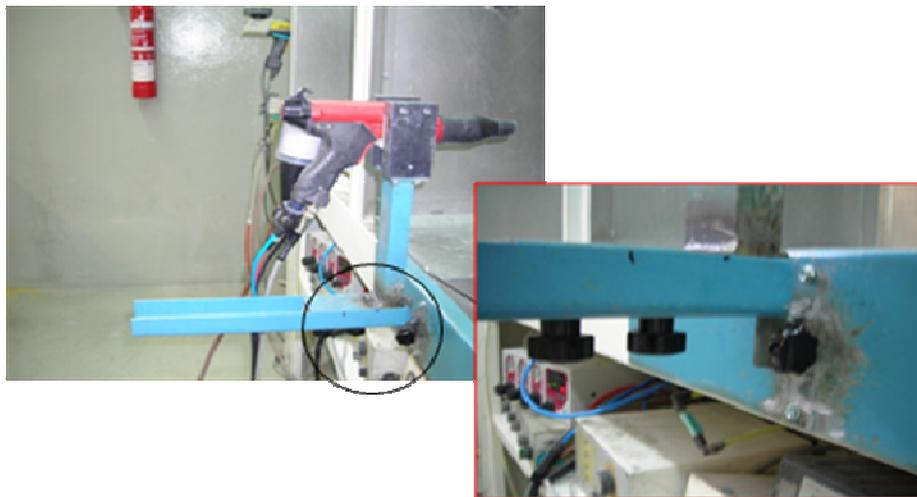
**Figura 19** – Fixação do braço de apoio da pistola.
