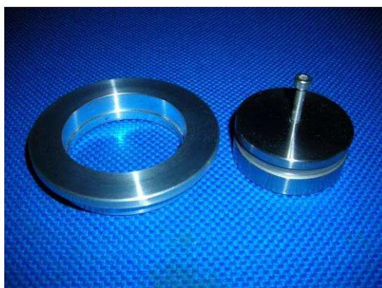
**Figura 11** – Forma de alumínio para a construção de pastilhas de tinta em pó.
