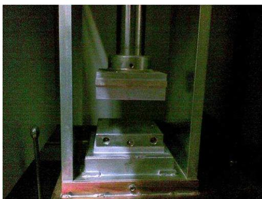
**Figura 12** – Prensa utilizada no fabrico das pastilhas.
