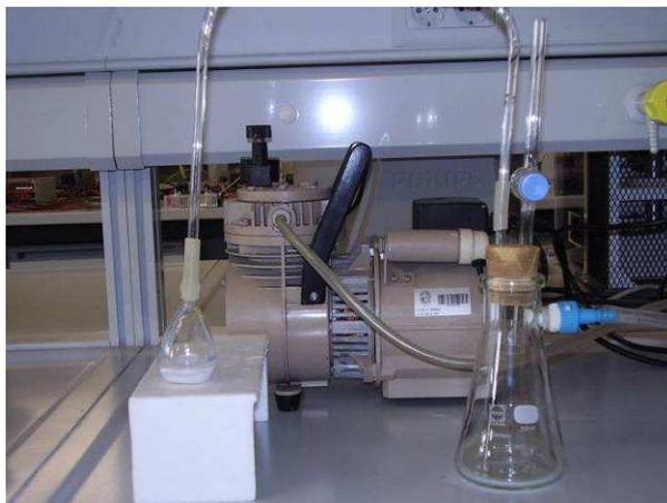
**Figura 10** – Instalação utilizada para a determinação da massa volúmica das tintas em pó (adaptado de [2]).
