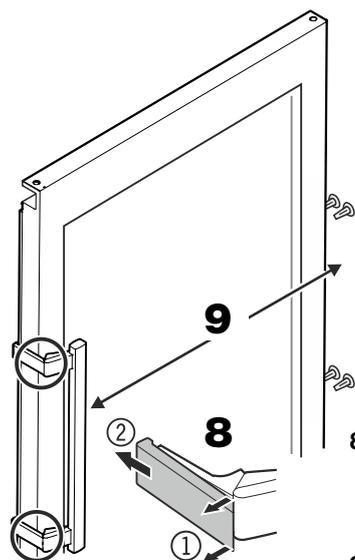
8. Desencaixar as placas de pressão na parte frontal ① e retirá-las puxando-as para trás ② .
