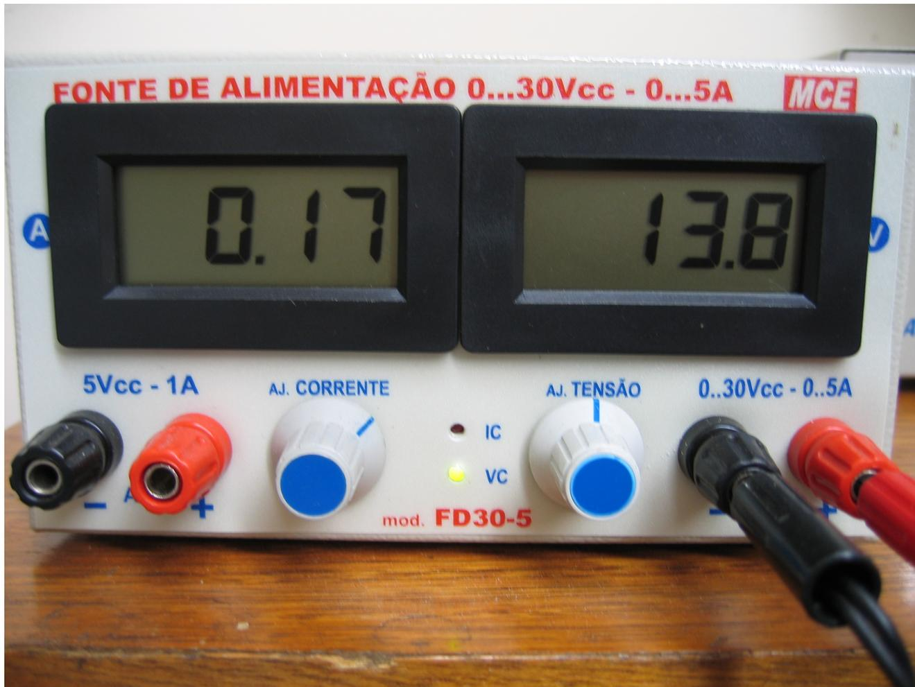
Figura 1. Fonte de tensão com o console da montagem conectado e ligado. Não alterar a regulagem de corrente. Voltagem ideal 13.8 V. **Voltagem máxima 16 V.**
