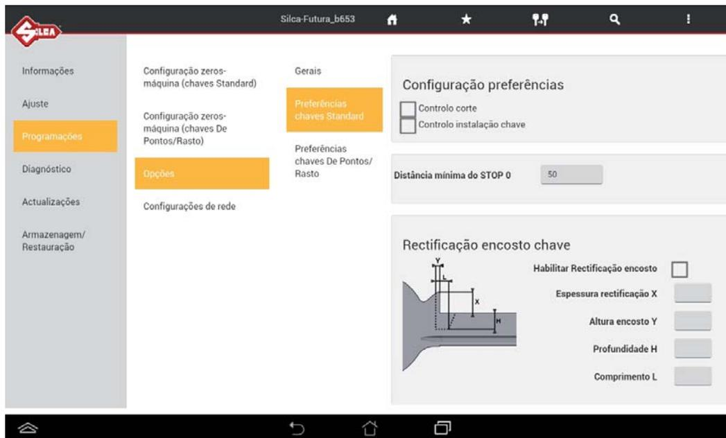
**Controlo do corte (Combinação não permitida):** em termos simples, quando esta função estiver habilitada, impede a Futura de aceitar cortes directos digitados pelo utilizador (ou decodificação errada), que de facto iria traduzir-se numa combinação de cortes não incluídos nos dados da ficha utilizada (e/ou não previstos pelo fabricante).
