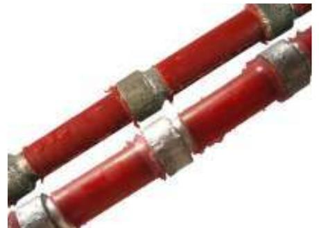
**Pedreira** – O fio para uso em pedreira para corte de granito, apresenta uma pérola de 11mm, com cabo usualmente envolto em borracha. Para mármore, o fio apresenta uma pérola de 10.5mm, com cabo envolto em molas.
