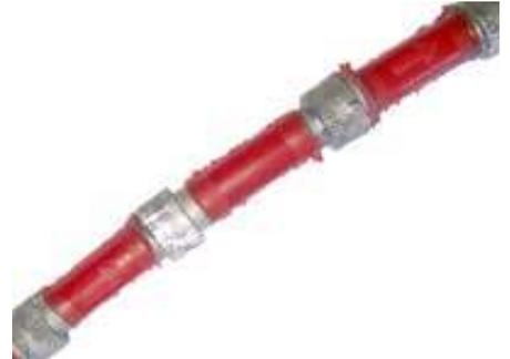
**Talha Bloco** – Normalmente para corte de granito, este fio apresenta uma pérola de diâmetro 11mm, sendo o cabo envolto em plástico. No caso para corte de mármore, apresenta uma pérola de 10.5mm, podendo o cabo ser envolto em molas e plástico, como o exemplo ao lado, ou apenas em plástico.
