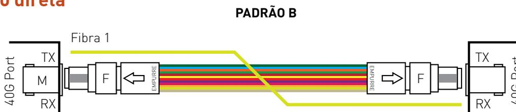
Para **conexão direta** entre ativos, devem ser utilizados **cordões em polaridade TIPO-B**, com isso **estaremos conectando TX com RX**. Sempre deve ser observado o padrão macho/fêmea sendo que, de maneira geral, os equipamentos apresentam interfaces tipo macho, portanto, os cordões utilizados devem apresentar conectores fêmea.
