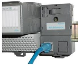
**Figura 6-6 Expansor de Barramento**
