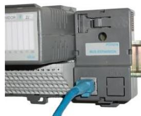
**Figura 3-6 Módulo Expansor**
