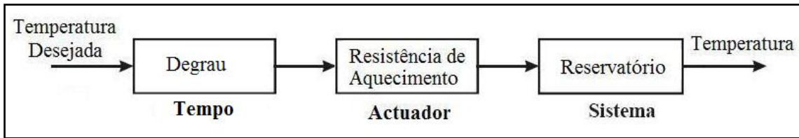
Figura 20 – Controlo da temperatura em malha aberta
