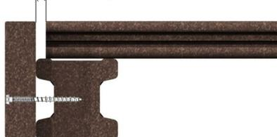
Pré-perfurar a tábua com uma broca de 3,5 mm, em seguida aparafusar directamente o parafuso compósito.
