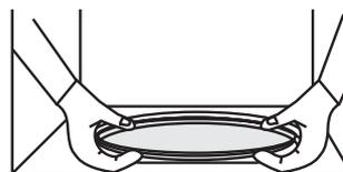
Não esquecer de colocar o sistema de tracção, o suporte com rodas, e o prato rotativo.
