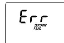
**Inverted cuvettes (Cuvetes invertidas):** A cuvette de amostra e a de zero estão invertidas.
