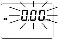
**Abaixo da gama:** Um "0.00" a intermitente indica que a amostra absorve menos luz que a referência zero. Verifique o procedimento e assegure-se que utiliza a mesma cuvete para a referência (zero) e a medição.
