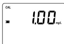
**Nota:** Se o mostrador indicar “STD HIGH”, o valor padrão era demasiado alto. Se o mostrador indicar “STD LOW”, o valor padrão era demasiado baixo. Verifique que ambos as Cuvetes A e B de Padrão CAL CHECK™ HI 96724-11, se encontram livres de impressões digitais e que estão inseridas correctamente.
