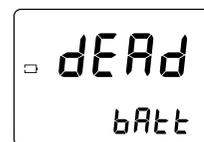
**Dead battery (Pilha morta):** Isto indica que a pilha está morta e deve ser substituída. Uma vez que seja indicada esta mensagem, o medidor bloqueia. Substitua a pilha e reinicie o medidor.
