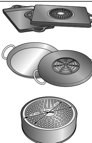
Al utilizar recipientes grandes con un área ferromagnética de diámetro más pequeño, se calienta únicamente la zona ferromagnética, de manera que la distribución de calor puede no ser homogénea.
