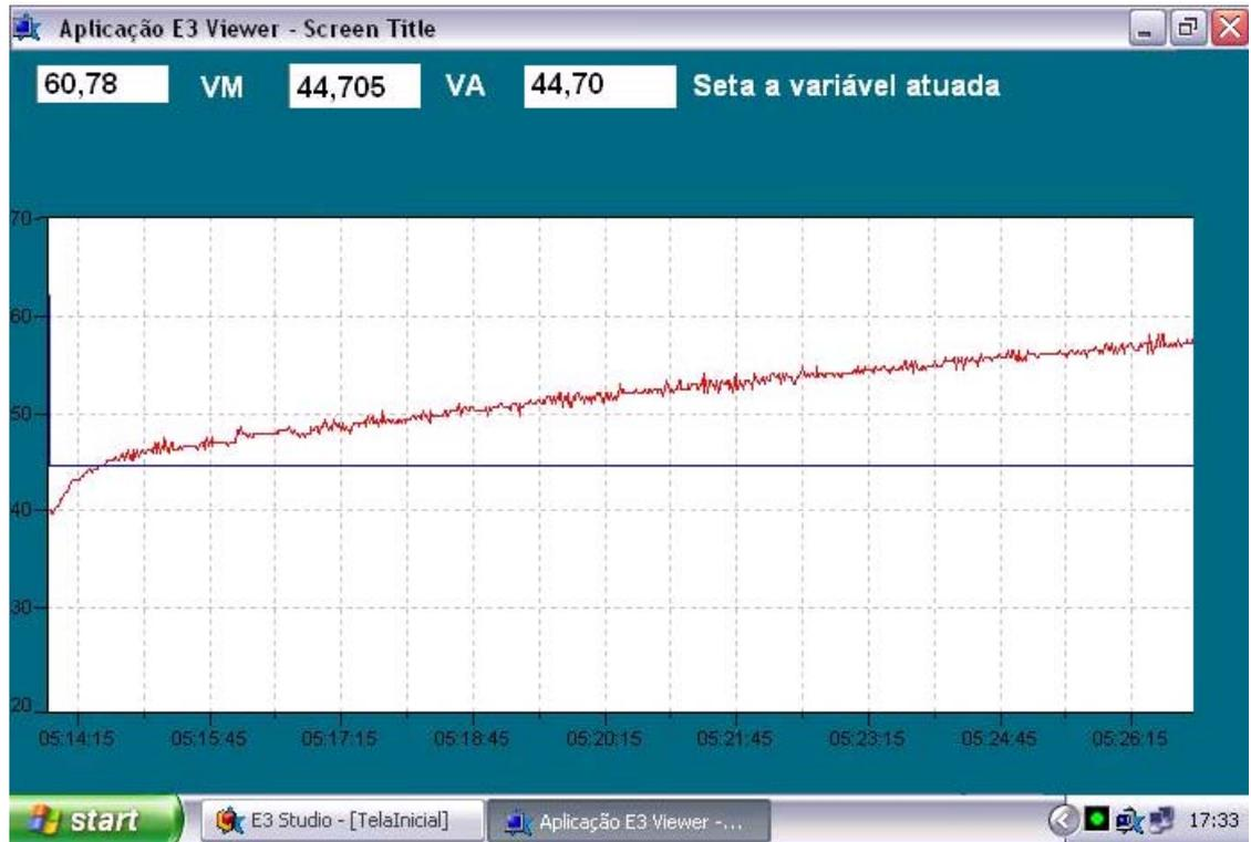
FIGURA 31: Tela de supervisão para coleta de dados para o método de Ziegler Nichols.
