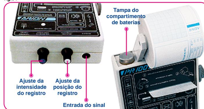
**Substituição das Baterias:** Ao ligar o equipamento, caso seja observada a indicação luminosa no painel frontal, deve-se substituir as baterias. Para tal basta desrosquear a tampa do compartimento de baterias, remover as quatro baterias usadas e substituí-las por novas, seguindo a polaridade informada no painel principal. As baterias utilizadas são do tipo CR2 3V de lítio.
