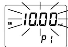
**Over Range:** Quando o valor máximo de gama aparece a piscar, significa que a amostra tem uma concentração superior à gama programada: dilua a amostra e efectue novamente o teste.
