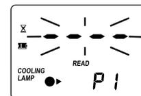
**Cooling lamp:** O instrumento espera que a lâmpada arrefeça.
