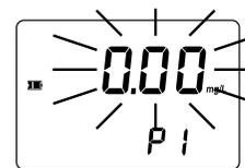
**Under range:** Quando pisca o símbolo "0.00" significa que a amostra absorve menos luz que o zero. Verifique o procedimento e certifique-se que está a usar a mesma cuvete para as duas situações (zero e medição).
