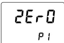
**Zero:** Não foi efectuada a leitura do zero. Siga as instruções do procedimento de medição para efetuar o zero ao instrumento.
