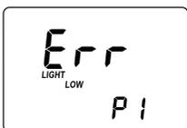
**Light Low:** Não existe luz suficiente para efectuar medições. Por favor verifique a preparação da cuvete para o zero.
