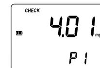
A leitura deve estar de acordo com as especificações descritas no Certificado do Padrão CAL CHECK™. Se o valor estiver fora das especificações, por favor verifique se as cuvetes não têm manchas, dedadas, ou sujidade e repita o processo. Se o erro persistir, recalibre o medidor.
