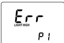
**Light High:** Existe luz a mais para efectuar medições. Por favor verifique a preparação da cuvete para o zero.
