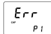
**Cap error:** Aparece quando a luz externa entra na célula de análise. Verifique se a tampa da cuvete está bem colocada.
