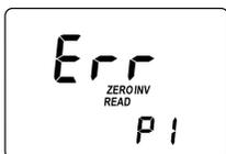
**Inverted cuvets:** As cuvetes do zero e da amostra estão invertidas.
