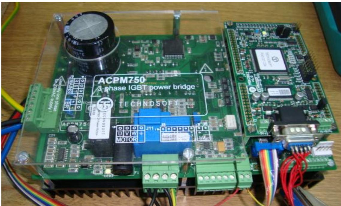
Figura 6.3 – Módulo de potência a IGBT trifásico ACPM750 utilizado na plataforma experimental
