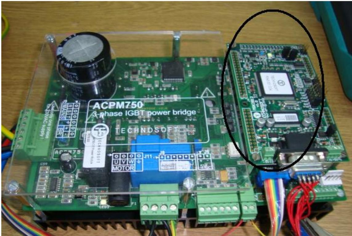
Figura 6.7 – Destaque da Placa MSK2812 com o DSP TMS320F2812 incorporado.
