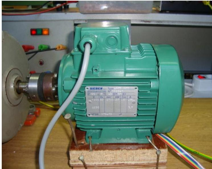
Figura 6.2 – Máquina assíncrona trifásica presente na plataforma experimental
