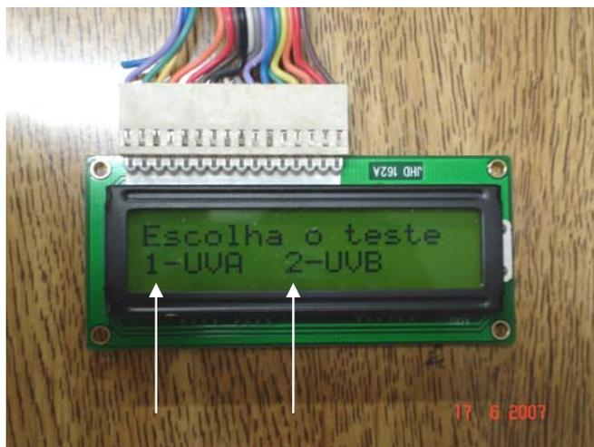
Figura 17 – Display exibindo a seleção de teste
