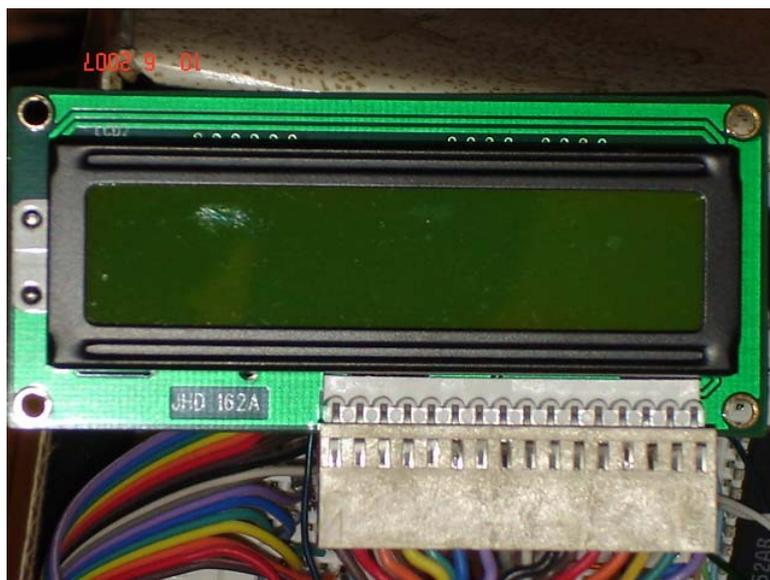
Figura 9 – Foto do LCD utilizado
