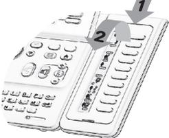
O seu telefone pode estar equipado com um módulo de extensão. O aparelho dispõe, assim, de teclas adicionais que podem ser configuradas como teclas de função, teclas de linha, teclas de chamada ...
