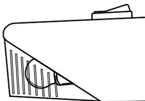
2. Remplacer l'ampoule par une ampoule pour appareils ménagers de même puissance.
