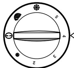
**REMARQUE** : Lors de la mise en marche initiale du congélateur, le compresseur fonctionne constamment, jusqu'à ce que la caisse soit refroidie. Ce refroidissement peut demander jusqu'à 6 ou 8 heures (ou plus), selon la température ambiante et la fréquence des ouvertures du congélateur. Lorsque la caisse est refroidie, le compresseur s'arrête et recommence au besoin, pour maintenir le congélateur à la température appropriée.
