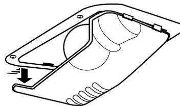
3. Remplacer l'ampoule par une ampoule pour appareils électroménagers de même wattage.
