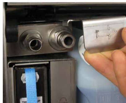
Figura 52. Tampa de enchimento/drenagem remotos aberta com tubo de reagentes (esquerda) e tubo de resíduos de parafina (direita).
