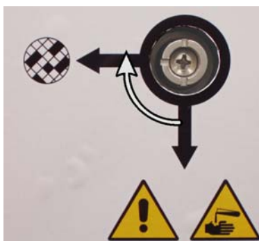
Figura 20. A válvula de selecção de vapores na posição do filtro interno
