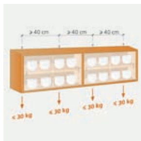
Fig. 2 Distribuição da carga
