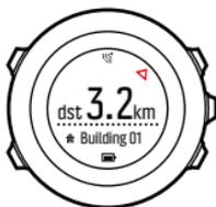
Enquanto se desloca (>4 km/h), o dispositivo exibe a direção para o PDI (ou ponto de referência se estiver a navegar num percurso) com base no GPS.
