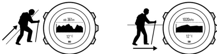
Não é possível medir simultaneamente alterações climáticas e de altitude, pois ambas provocam alteração da pressão atmosférica envolvente. Suunto Ambit3 Peak deteta movimento vertical e passa para a medição de altitude quando assim é necessário. Quando a altitude é apresentada, a sua atualização demora 10 segundos no máximo.
