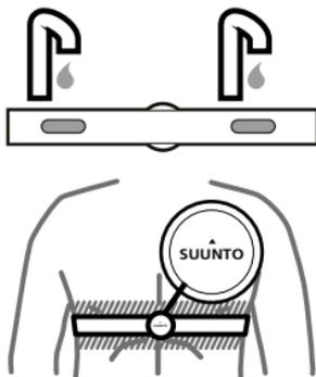
O Smart Sensor liga-se automaticamente logo que deteta uma batida cardíaca.
