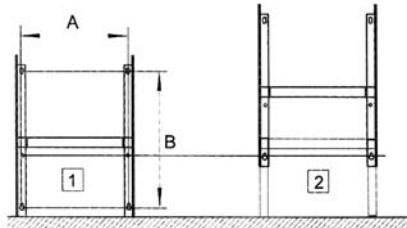
Nota : Está formalmente prohibido utilizar el aparato en configuración móvil, sobre pies o sobre ruedas. (esquema 3bis)
