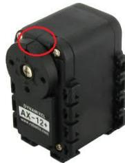
Figura 3.5: Alinhamento entre a parte móvel e a estrutura do servomotor (*AX-12*)
