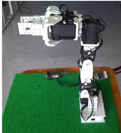
Figura 3.6: Braço manipulador com os servos alinhados
