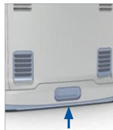
**PRECAUÇÃO** A bateria do Inogen One® G3 serve de fonte de alimentação secundária em caso de corte previsto ou imprevisto da corrente CA ou CC externa. Quando utilizar o Inogen One® G3 a partir de uma fonte de alimentação de CA ou CC externa, deve manter no Inogen One® G3 uma bateria correctamente inserida. Deste modo, garante um funcionamento ininterrupto, fazendo soar todos os alarmes e alertas em caso de corte de electricidade da fonte de alimentação externa.
