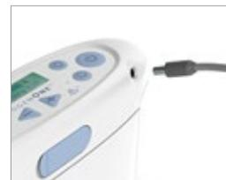
**PRECAUÇÃO** Certifique-se de que a fonte de alimentação está num local bem ventilado, dado que ela depende da circulação do ar para dissipar o calor. A fonte de alimentação pode aquecer durante o funcionamento. Deixe arrefecer a fonte de alimentação antes de a manusear.
