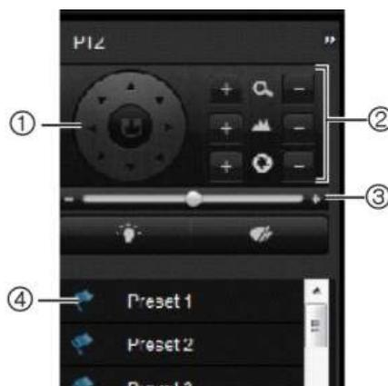
1. Botões direccionais de pad/auto-scan: controlam os movimentos e as direcções do PTZ. O botão central é utilizado para iniciar a função de auto-pan pela câmara PTZ de dome.
