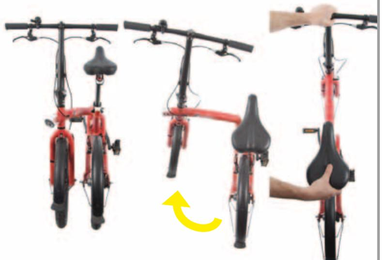
3. Abra a bicicleta soltando a manete POP-UP. Posição das mãos: mão esquerda a meio do guidador, mão direita na parte de trás do selim. O bloqueio na posição de quadro desdobrado é automático.
