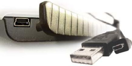
A tomada USB localiza-se sob o molde de borracha no lado esquerdo do instrumento.
