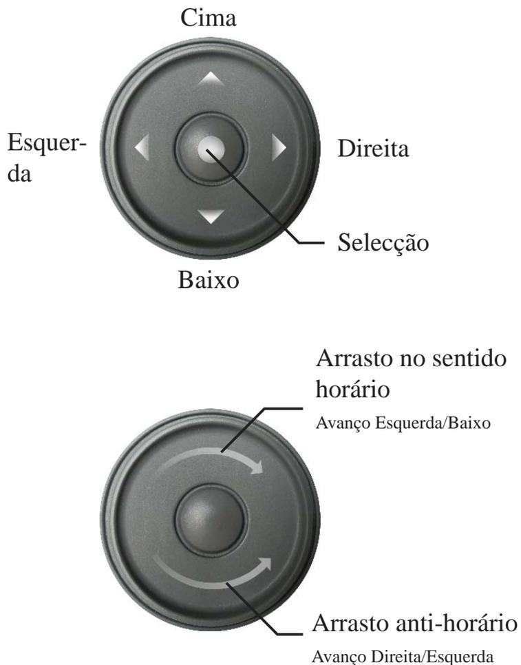
O medidor é controlado utilizando uma roda sensível ao toque e um botão de selecção distinto no centro da roda.
