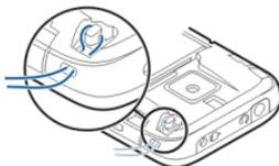
Introduza a pulseira de transporte conforme indicado na figura e aperte-a.
