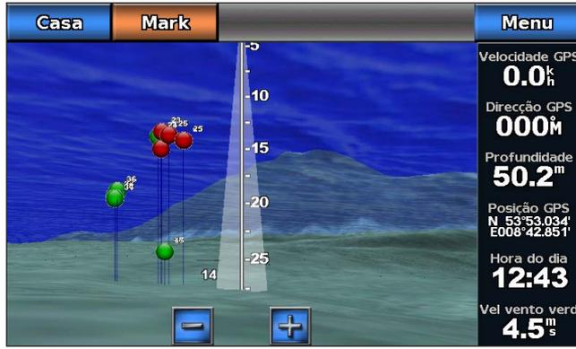
Fish Eye 3D com um cone da sonda
