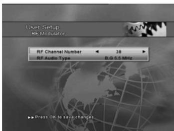
Pode também fazer ajustamentos para o modulador de RF. O Canal 38 vêm configurado de fábrica, deve sintonizar a sua TV neste canal para ver o que o receptor envia. Se este canal estiver a ser usado como canal de transmissão ou se está a ter interferências neste canal, pode mudar o canal para um nº não usado.
