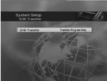
O programa de firmware no receptor principal pode ser transferido deste receptor para outro receptor (escravo) E Ligue o cabo null modem entre os dois receptores.
