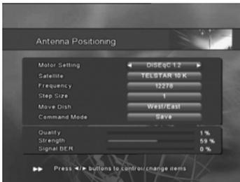
De forma a poder usar o posicionador de antena tem de usar um motor controlado por comandos DiSEqC 1.2, este modo permitir-lhe-á configurar a posição da antena para cada satélite.
