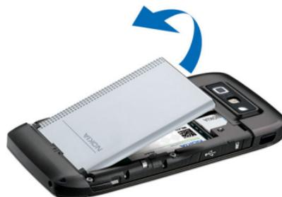
3. Introduza o cartão SIM. Certifique-se de que a área dos contactos do cartão fica virada para os conectores do dispositivo e de que o canto biselado do cartão fica virado para a parte de cima do dispositivo.
