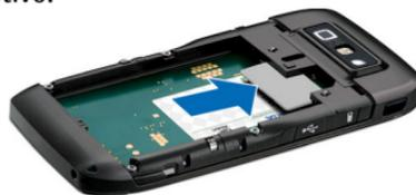
4. Introduza a bateria. Alinhe os contactos da bateria com os conectores correspondentes do compartimento da bateria e insira-a na direcção da seta.
