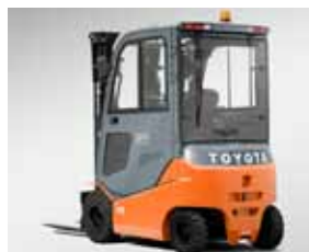
Cabine em aço
