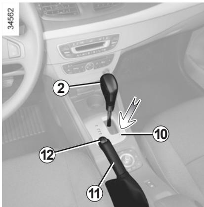
**Ao pôr o motor a trabalhar, se a alavanca ficar bloqueada na posição **P**, com o pé no pedal de travão e o botão de destravamento **2** premido, é possível desbloqueá-la manualmente. Para isso, introduza um objecto no orifício **10** e, ao mesmo tempo, prima o botão de destravamento **2** situado na alavanca.**
