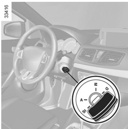
Antes de proceder ao reboque, insira a chave no interruptor da ignição para destrancar a coluna de direcção. Rode-a para a posição **M**.
