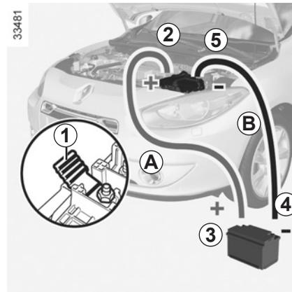
Accione o motor e desligue os cabos **A** e **B** pela ordem inversa (**5 - 4 - B - 2**).
