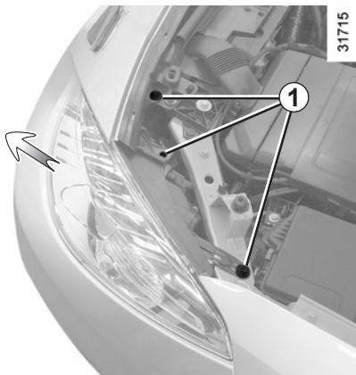
Pode substituir pessoalmente as lâmpadas a seguir indicadas. No entanto, aconselhamo-lo a mandar efectuar essa substituição num representante da marca, se a manipulação lhe parecer difícil. Depois de abrir o capô, desaperte os parafusos **1** com auxílio de ferramentas correntes ou, consoante a versão do veículo, com as chaves fornecidas no bloco de ferramentas. Puxe o farol na direcção indicada pela seta, até ao batente.
