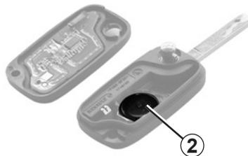
**Nota:** aquando da substituição da pilha, não toque no circuito eléctrico gravado na tampa da chave.
