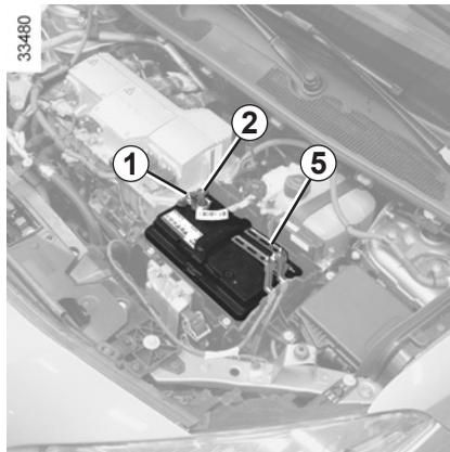
Fixe o cabo positivo **A** ao **suporte 1** fixo ao borne **2 (+)** e depois ao **borne 3 (+)** da bateria dadora.
