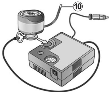
Logo que o pneu esteja à pressão preconizada, retire o kit: desaperte lentamente a ponteira de enchimento **10** de modo a evitar a projecção de produto e guarde a garrafa numa embalagem plástica para evitar que o produto escorra.
