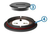
5 Coloque a nova bateria por baixo das duas patilhas de plástico (§) e pressione para a colocar na posição correcta. Não danifique os contactos (§).
